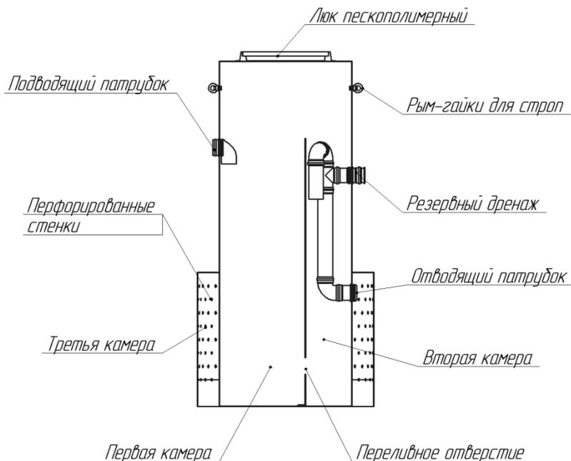
Рисунок 2 – Принцип работы септика SANI-S
