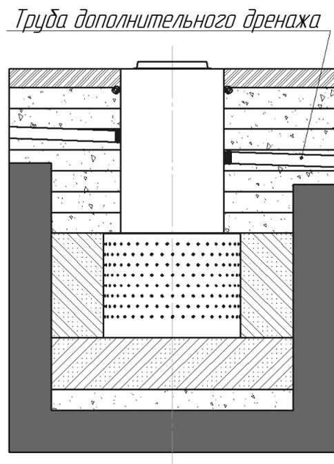
Рисунок 9 – Подключение дополнительного дренажа
